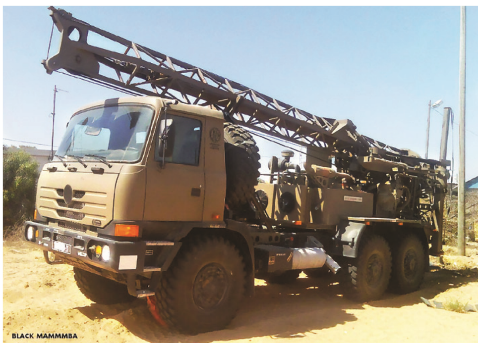
טאטרדריילר: מקדח בורות על משאית הוא אחד מכלי הצמ"ח העיקרי של צה"ל בחשיפת מנהרות הטרור של רצועת עזה. (צילום: Black Mammba):
