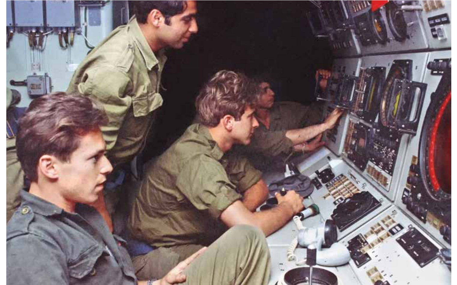
למעלה: מערכת נשק גבריאלי במרכז ידיעות הקרב (מי"ק) בבטן סטי"ל; מימין - יחידת ציון מטרות; משמאל - מכ"ם בקרת האש מימין: סירות קומנדו מסוג סנונית
