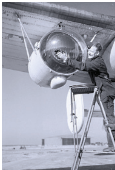
זרקור מתואם מכ"ם על גבי מפציץ B-24 ("ליברטור") ארוך טווח של פיקוד החופים של חיל האוויר המלכותי, פברואר 1944. רק עם התקנתם של זרקורים מתואמים אלה הפך הסיור האווירי לקטלני באמת. (Royal Air Force official photographer: Miller (F/O), Imperial War Museums)
