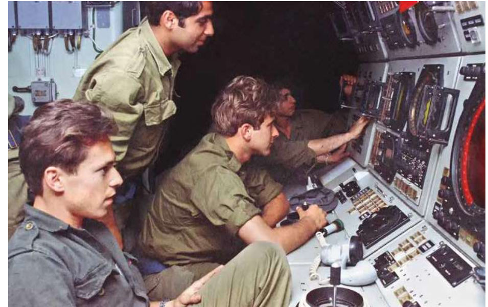
למעלה: מערכת נשק גבריאל במרכז ידיעות הקרב (מ"ק) בבטן סטי"ל; מימין - יחידת ציון מטרות; משמאל - מכל"ם בקרת האש מימין: סירות קומנדו מסוג סנונית
