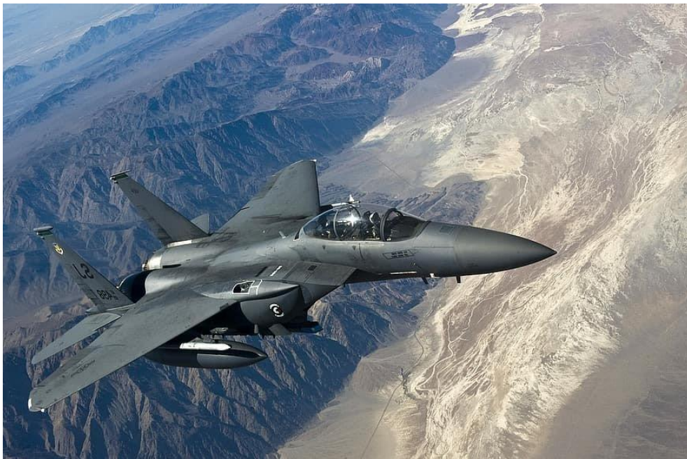
תמונה 6: מטוס ה־F-15E שהיה מיועד לתקוף יעדים בקרקע בנוסף לייעודו כמטוס מיירט [74]
