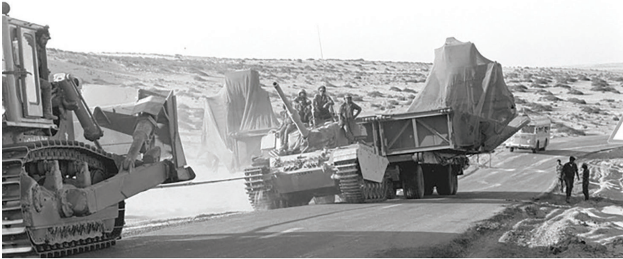
דחפור וטנק מחלצים דוברת שהורדה אל שולי הכביש. ארכיון צה"ל. צלם: בני הדר.
