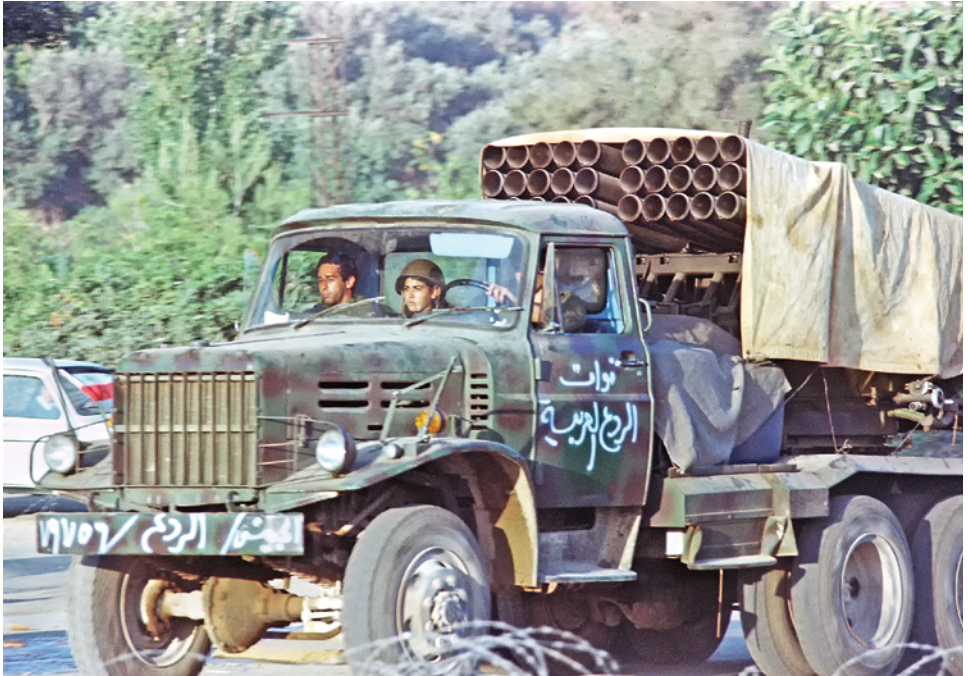
משגר רקטות גראד (122 מ"מ) מתנייע מדגם בי-אם-21. על דלת המשאית כתוב בערבית "כוח ההרתעה הערבי" (באדיבות דובר צה"ל).
